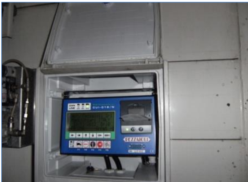
Figura 4.3. Vehículos con sistema de control de temperatura y registro automático permiten un ajuste más fácil y preciso de los parámetros de temperatura y ventilación dentro del compartimento animal.
